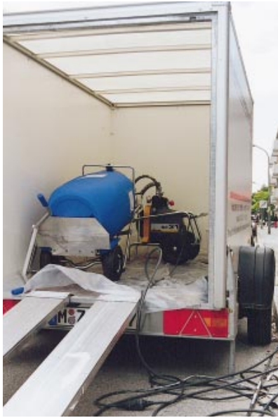
1 Großgebilde statt Eimer: 120-Liter-Fass und Pumpe sind im Anhänger untergebracht. Das minimiert die Rüstzeiten bei Arbeitsanfang und -ende.
